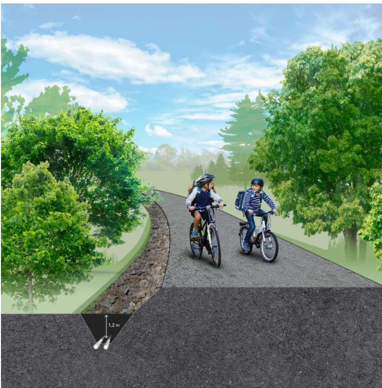
Figur 1. Kabelförläggning i banvallen samt illustration av cykelväg.
